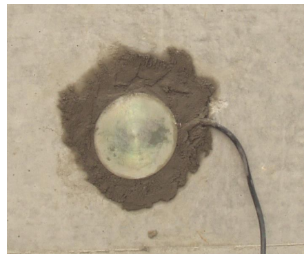
图 3 土压力盒埋设实物图 Fig.3 Photograph of a earth pressure cell
